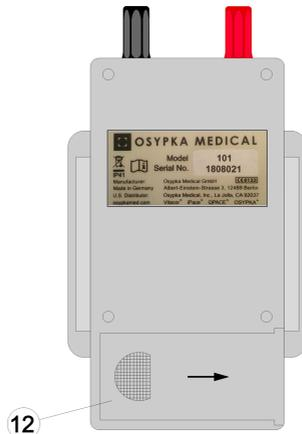
Figura 3: Acceso al compartimento de la batería
