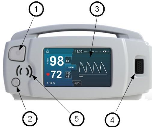
1. **Botón de encendido:** Pulse una vez para encender el equipo. Mantenga el botón pulsado al menos **un (1)** segundo para apagarlo.
