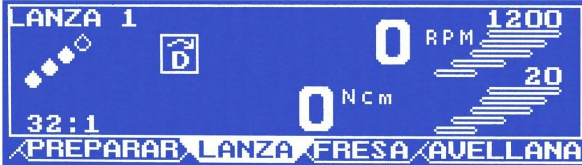
La figura anterior nos muestra, en la parte inferior de la pantalla, una solapa resaltada en blanco indicando la función que está activa (en este caso la función LANZA) y que podemos programar.
