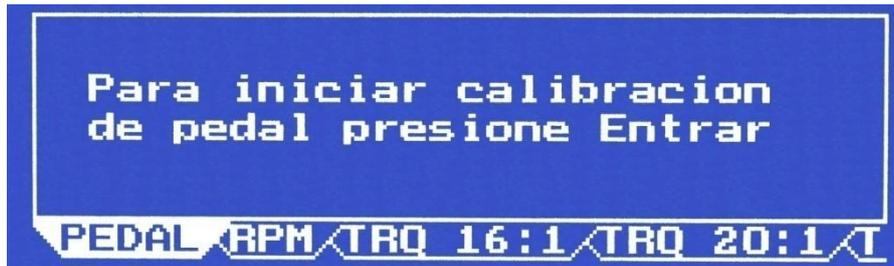
La primera opción (PEDAL) permite calibrar el pedal para la función lineal o gradual del mismo. Para calibrar el pedal pulse la tecla **ENTRAR** y siga las instrucciones en pantalla.
