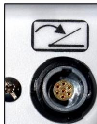
El conector macho para el micromotor se encuentra en el frente del equipo abajo a la derecha (ver figura siguiente), para conectar el micromotor debe hacer coincidir la ranura del conector hembra con la guía que tiene el conector macho, a continuación, inserte y presione el conector hembra hasta hacer tope; una vez hecho esto debe ajustar la tuerca que acompaña al conector del cable del micromotor.
