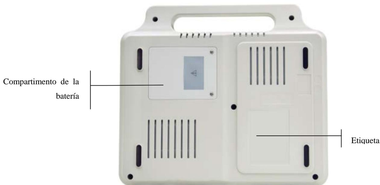
Figura 3-8 Parte posterior del panel
